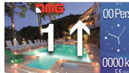
Matisse 7" | 10" 65000 colori 800x480 pixel Multifunzione Luce di emergenza Sintesi vocale Associazione di immagini, audio e video a ogni piano
